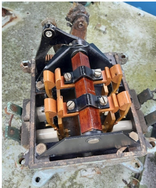
Figure 30 : Vues du mécanisme du fin de course
