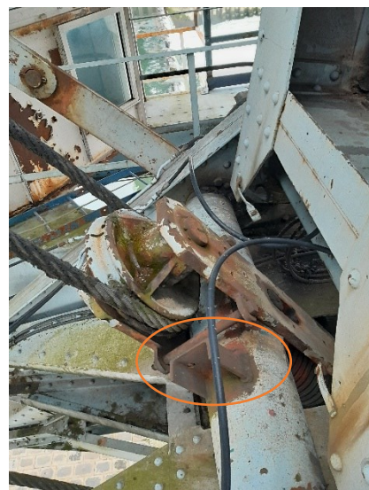
Vues sur la plateforme basse du chariot (photo 1 et 2 de droite à gauche) Suspension supérieure du câble : poulie du câble et système d'accroche du « chapeau » (en orange)
