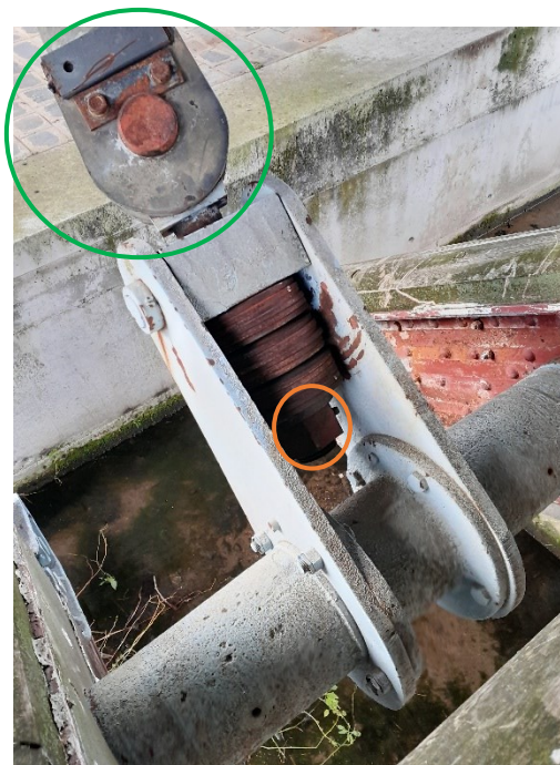
Vue du système de fixation inférieur depuis la zone de garage du chariot Ecrou de mise sous tension des rondelles belleville identifié en orange Noix permettant la liaison entre le système de tension inférieur et le câble (identifié en vert) Photos 5 et 6 de droite à gauche
