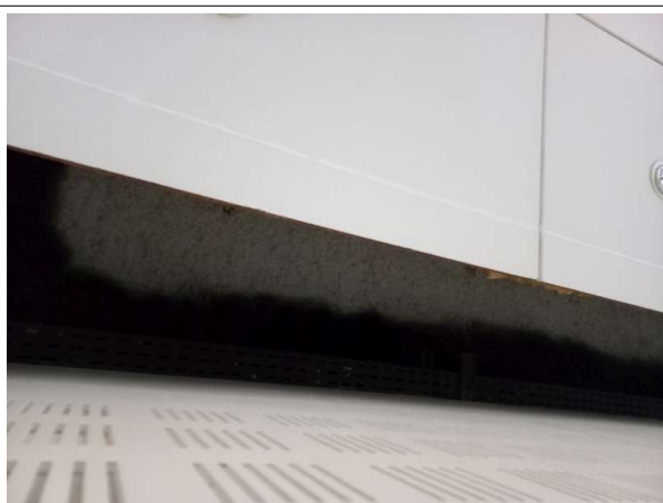
Prélèvement - P457 : R+1 / Couloir B - Flocage- (Absence d'amiante)
