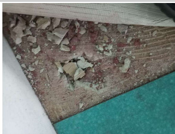
Prélèvement - P302 : R+4 / Bureau 2 - Colle bitumineuse- (Présence d'amiante)
