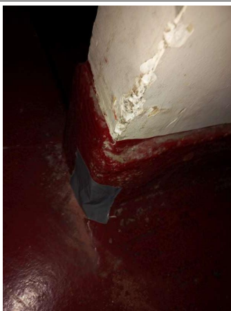
Prélèvement - P156 : R+1 / Palier escalier C - Colle de plinthe- (Absence d'amiante)
