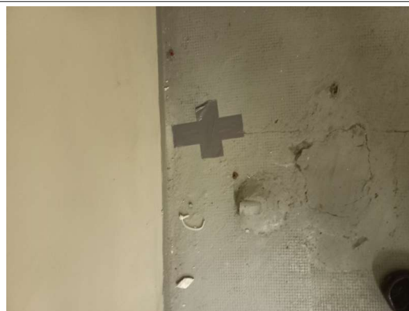
Prélèvement - P107 : R-1 / Dégagement - Peinture sur béton- (Absence d'amiante)
