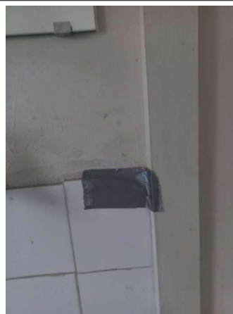
Prélèvement - P06 : R+4 / Local photocopie - Colle de faïence- (Absence d'amiante)
