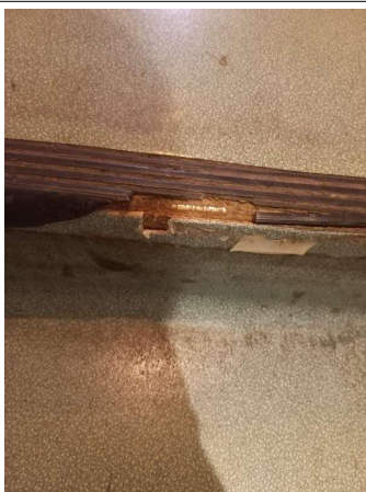
Prélèvement - P269 : R+0 / Dégagement sanitaires - Nez de marche- (Absence d'amiante)
