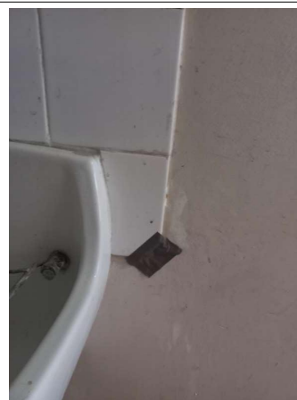
Prélèvement - P234 : R+0 / Palier escalier C - Colle de faïence- (Absence d'amiante)
