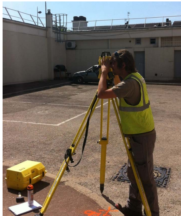
Figure 10 : Levé à la station totale
