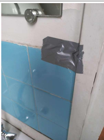
Prélèvement - P15 : R+4 / Sanitaires - Colle de faïence- (Absence d'amiante)
