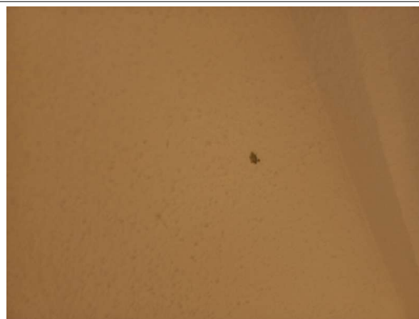
Prélèvement - P385 : Entresol R+1 / Bureau 1 - Enduit- (Absence d'amiante)
