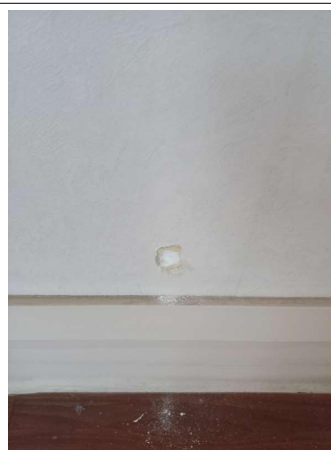
Prélèvement - P332 : R+1 / Bureau 29 - Enduit- (Absence d'amiante)
