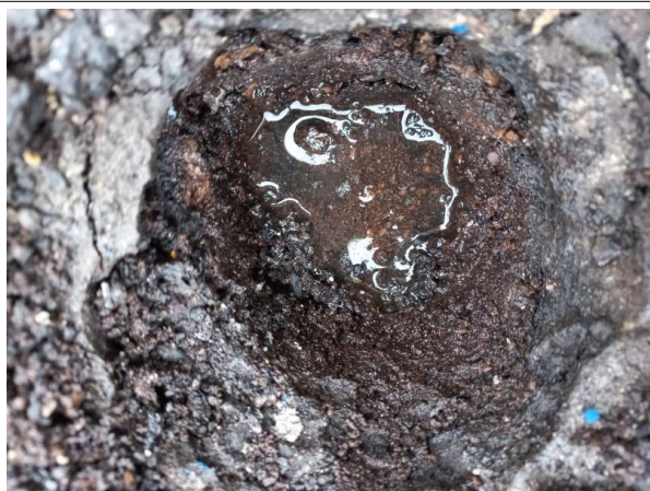
Prélèvement - P347 : R+2 / Toiture-terrasse - Complexe d'étanchéité asphalté- (Absence d'amiante)
