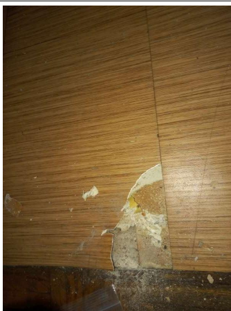
Prélèvement - P417 : Entresol R+1 / Logement 2 / Cuisine - Colle de carrelage- (Absence d'amiante)
