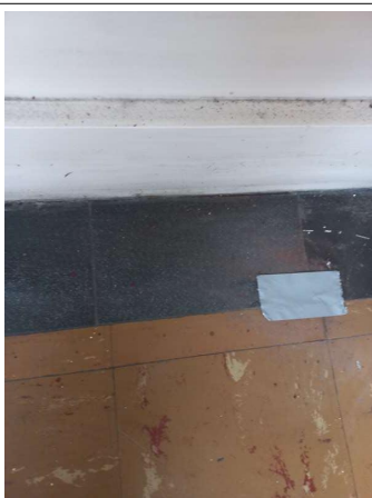
Prélèvement - P69 : R+2 / Couloir B - Colle bitumineuse- (Présence d'amiante)
