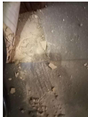
Prélèvement - P377 : R+0 / Bureau 6 - Colle bitumineuse- (Présence d'amiante)
