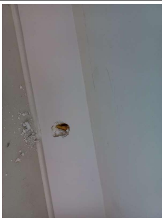
Prélèvement - P305 : R+4 / Bureau 2 - Enduit- (Absence d'amiante)
