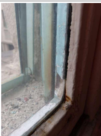
Prélèvement - P331 : R+1 / Bureau 29 - Joint de vitrage- (Absence d'amiante)
