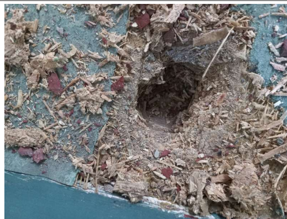
Prélèvement - P344 : R+1 / Bureau 5 - Colle bitumineuse- (Présence d'amiante)
