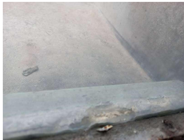
Prélèvement - P74 : R+2 / Sanitaires + WC 1 - Mastic- (Absence d'amiante)
