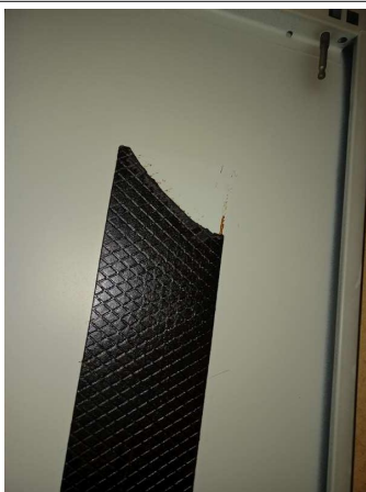
Prélèvement - P343 : R+1 / Bureau 33 - Plaquette souple bitumineuse antivibratile- (Présence d'amiante)
