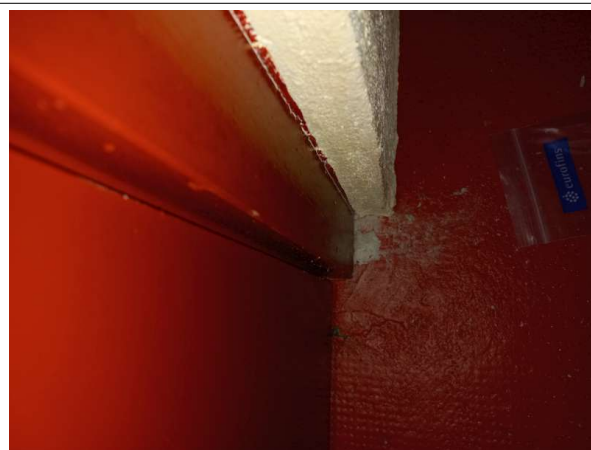
Prélèvement - P284 : R-2 / Archives 1 - Peinture sur béton- (Absence d'amiante)
