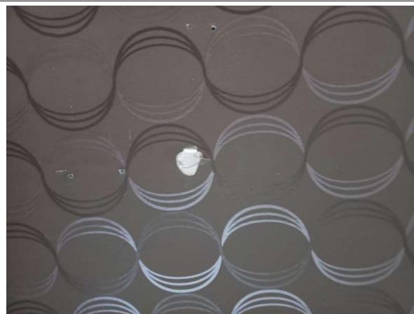
Prélèvement - P407 : Entresol R+1 / Logement 2 / Chambre 1 - Enduit- (Absence d'amiante)
