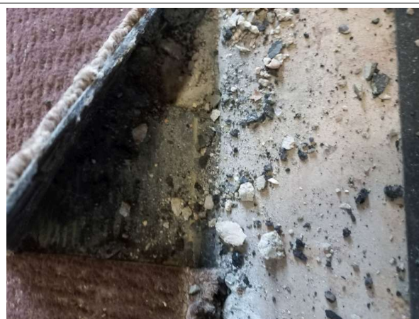
Prélèvement - P328 : R+1 / Accueil - Colle- (Absence d'amiante)
