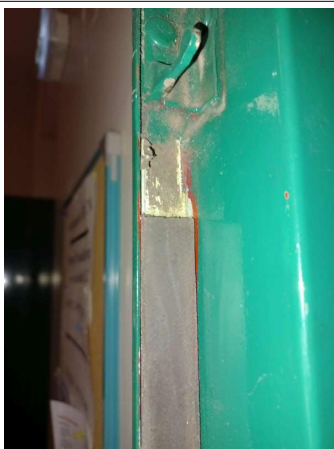
Prélèvement - P86 : Tout étage / Ascenseur - Joint de porte- (Absence d'amiante)
