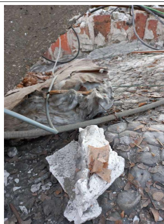
Prélèvement - P308 : R+5 / Combles - Isolant- (Absence d'amiante)
