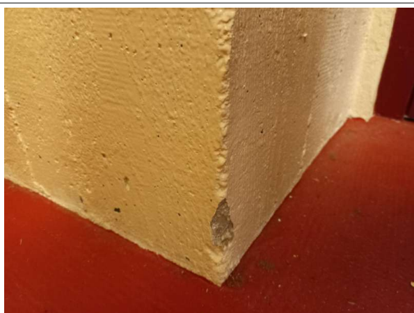
Prélèvement - P285 : R-2 / Archives 1 - Enduit- (Absence d'amiante)
