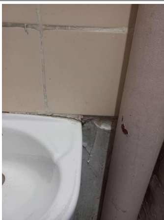
Prélèvement - P36 : R+3 / Dégagement sanitaires - Colle de faïence- (Absence d'amiante)
