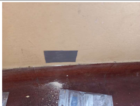
Prélèvement - P262 : R+0 / Gymnase - Enduit- (Absence d'amiante)
