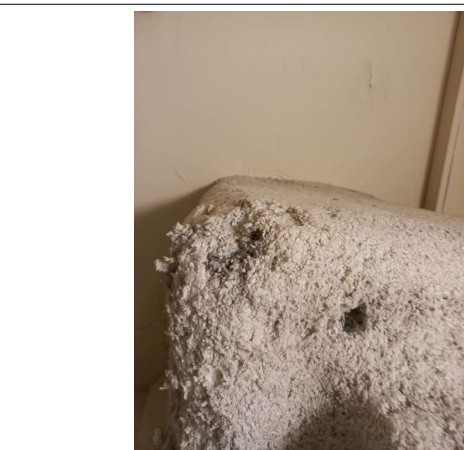
Prélèvement - P112 : R-1 / Dégagement - Flocage- (Absence d'amiante)
