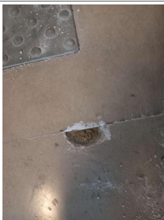
Prélèvement - P321 : R+2 / Palier escalier B - Colle- (Absence d'amiante)
