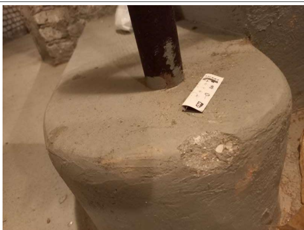
Prélèvement - P146 : R-1 / Couloir A - Peinture sur béton- (Absence d'amiante)
