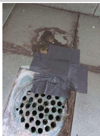
Prélèvement - P206 : R+1 / Sanitaires + WC couloir B - Colle de carrelage- (Absence d'amiante)
