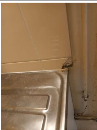
Prélèvement - P333 : R+1 / Cuisine - Colle de faïence- (Absence d'amiante)
