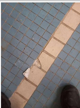
Prélèvement - P128 : R-1 / Piscine - Colle de carrelage- (Absence d'amiante)
