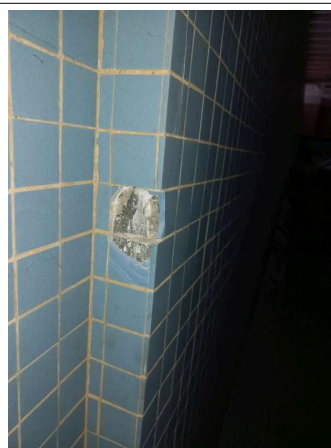
Prélèvement - P129 : R-1 / Piscine - Colle de faïence- (Absence d'amiante)
