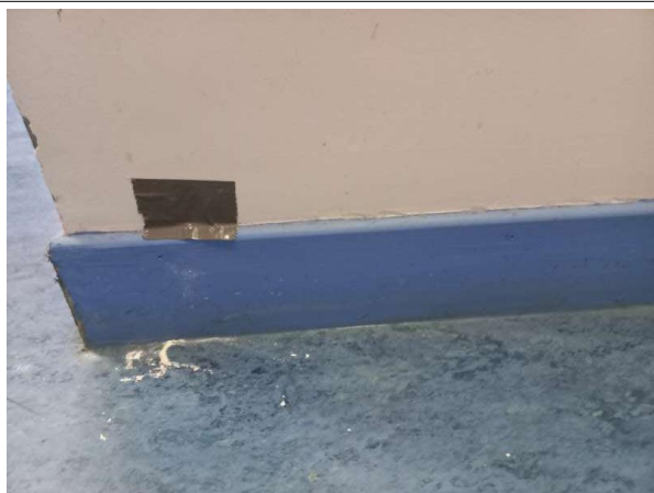
Prélèvement - P162 : R+1 / Dégagement informatique - Enduit- (Absence d'amiante)
