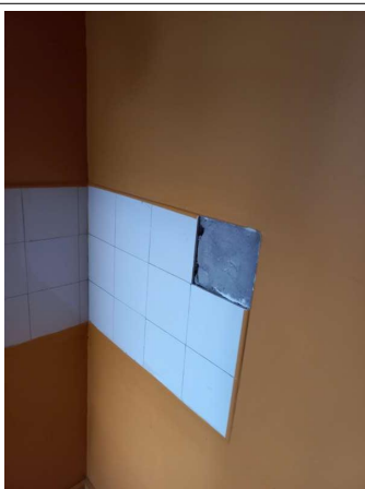
Prélèvement - P419 : Entresol R+1 / Logement 2 / Cuisine - Colle de faïence- (Absence d'amiante)
