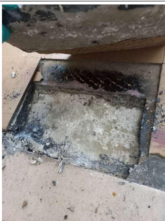
Prélèvement - P29 : R+3 / Couloir B - Colle bitumineuse- (Présence d'amiante)
