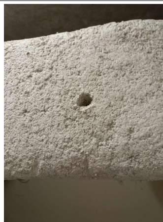
Prélèvement - P103 : R-1 / Dégagement - Flocage- (Absence d'amiante)
