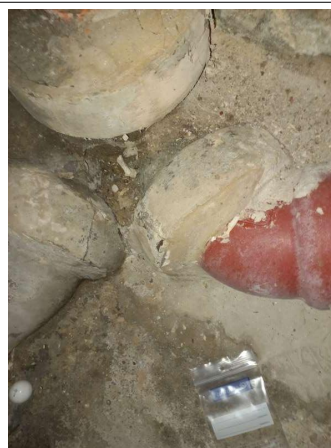
Prélèvement - P149 : R-1 / Cave 0 - Joint- (Absence d'amiante)
