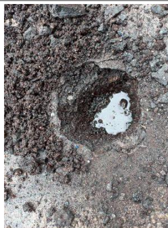
Prélèvement - P348 : R+2 / Toiture-terrasse - Complexe d'étanchéité asphalté- (Absence d'amiante)
