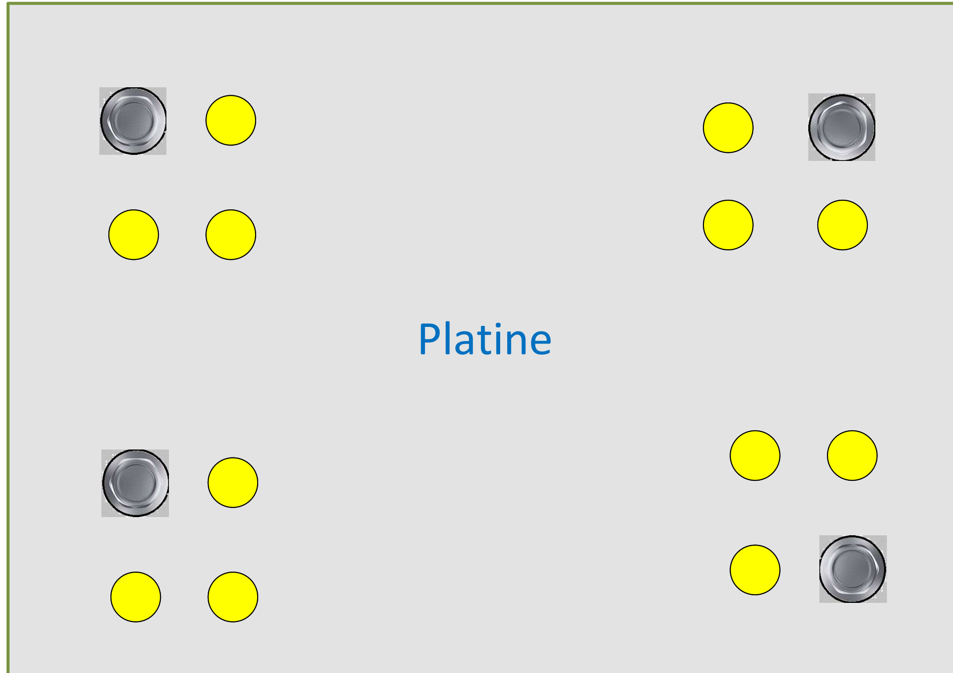
Cas 2 : pas de vérification du couple : Caps soudé
