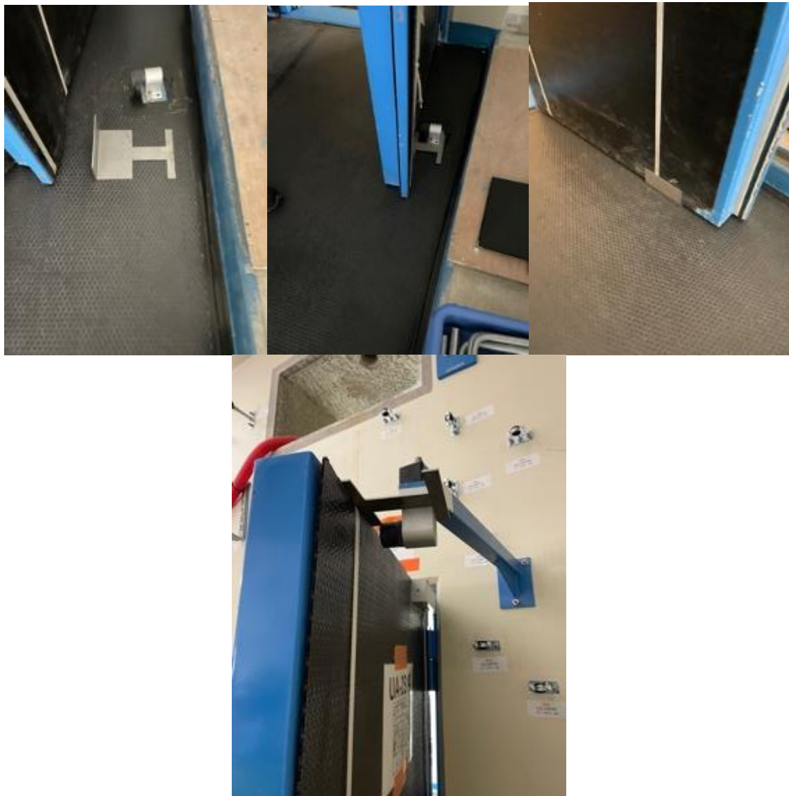
Figure 2 : calage des portes soit par le bas soit par le haut
