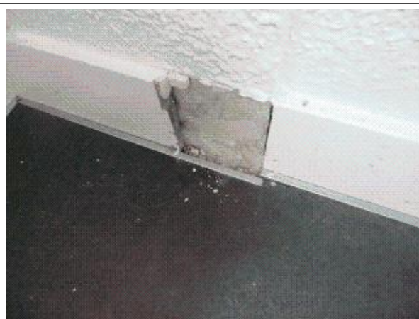
Prélèvement - P4 : CPAM / RDC / SALLE RESTO - Colle de plinthe- (Absence d'amiante)
