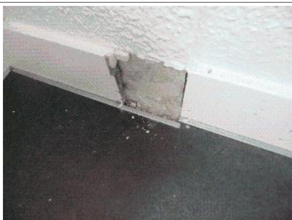
Prélèvement - P3 : CPAM / RDC / SALLE RESTO - Colle de plinthe- (Absence d'amiante)
