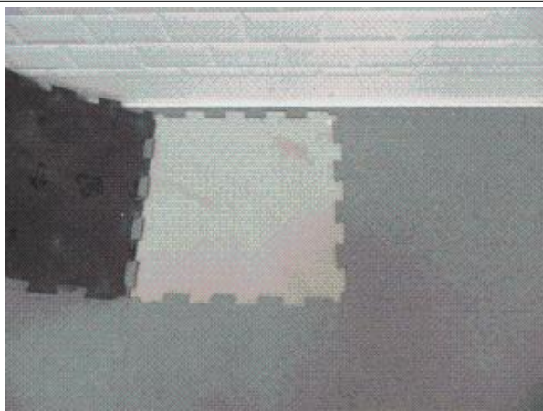
Prélèvement - P31 : CPAM / RDC / SALLE RESTO - Ragréage- (Absence d'amiante)
