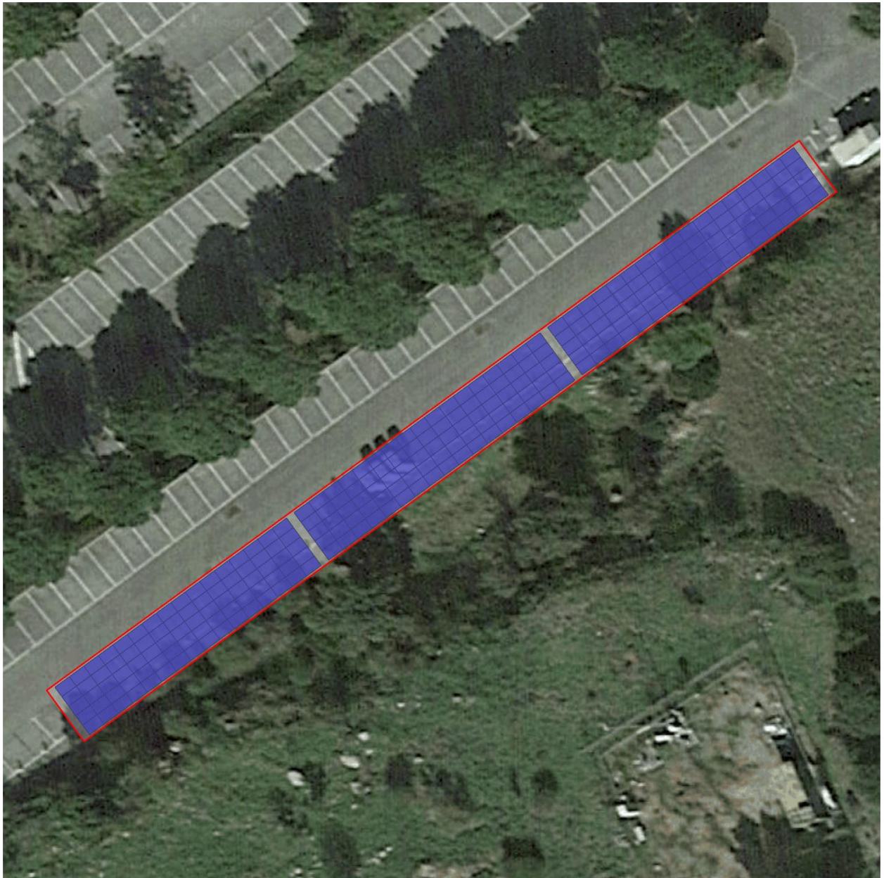
Vue aérienne avec calepinage d'avant-projet. Les modules de cet exemple sont des Jinko Solar Tiger Neo 420Wc, pour une puissance totale de 105 kWc
