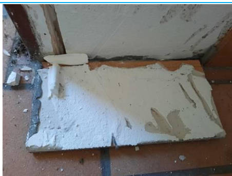
Matériaux : ZPSO-055 Prélèvement : P084 Description : Colle de plinthe carrelée Localisation : 1er étage - sanitaire chambre 110 Résultat : Absence d'amiante
