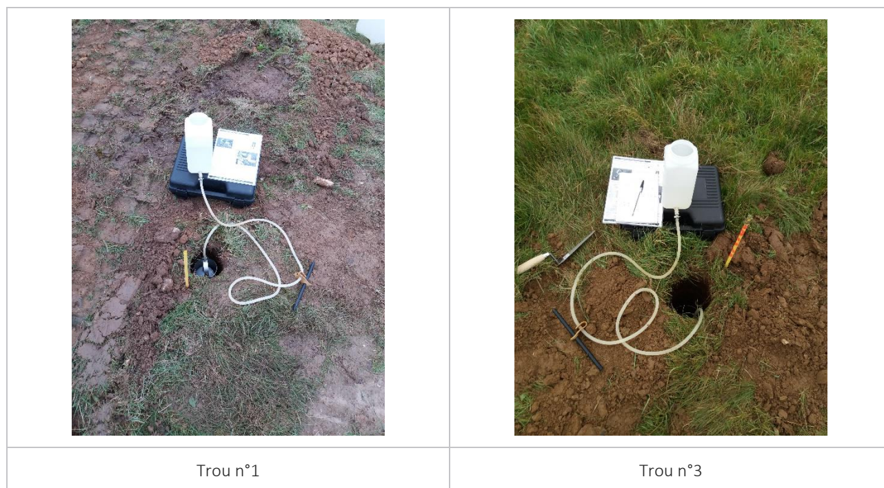
Figure 5 : Illustrations de la phase de mesure des essais de Porchet
