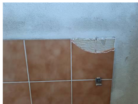
Matériaux : ZPSO-063 Prélèvement : P094 Description : Colle BLANCHE de faïence Localisation : 1er étage - sanitaire chambre 110 Résultat : Absence d'amiante
