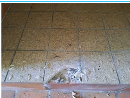
Matériaux : ZPSO-015 Prélèvement : P027 Description : Colle de carrelage anti-dérapant Localisation : Rez de chaussée - douches 2 Résultat : Absence d'amiante
