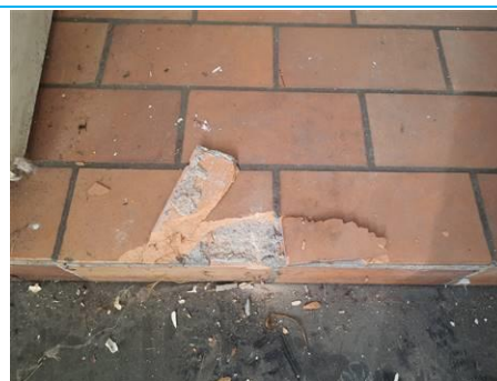
Matériaux : ZPSO-050 Prélèvement : P077 Description : Colle de carrelage Localisation : 1er étage - sanitaire chambre 101 Résultat : Absence d'amiante
