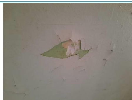
Matériaux : ZPSO-059 Prélèvement : P089 Description : Enduit+peinture mur Localisation : 1er étage - circulation 1 Résultat : Absence d'amiante
