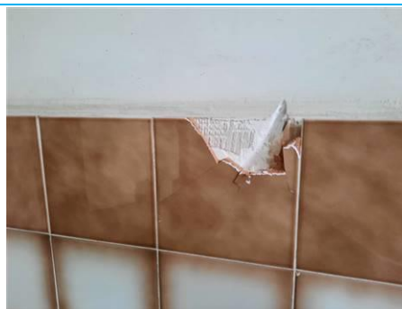
Matériaux : ZPSO-014 Prélèvement : P026 Description : Colle de faïence Localisation : Rez de chaussée - sanitaire chambre 15 Résultat : Absence d'amiante
