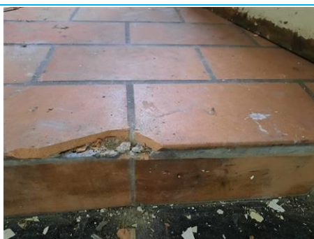
Matériaux : ZPSO-007 Prélèvement : P011 Description : Colle GRISE de carrelage sol Localisation : Rez de chaussée - sanitaire chambre 9 Résultat : Absence d'amiante
