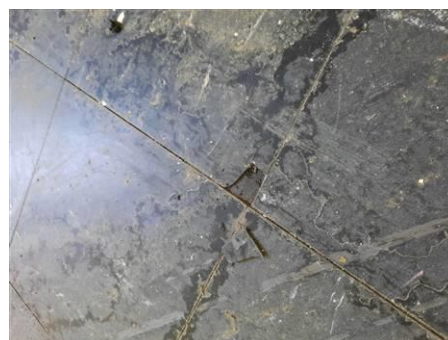
Matériaux : ZPSO-047 Prélèvement : P073 Description : Dalle de sol NOIRE+colle+ragréage Localisation : 1er étage - chambre 107 Résultat : Présence d'amiante
