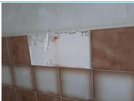
Matériaux : ZPSO-013 Prélèvement : P023 Description : Colle de faïence Localisation : Rez de chaussée - sanitaire chambre 9 Résultat : Absence d'amiante
