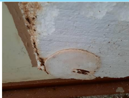
Matériaux : ZPSO-022 Prélèvement : P039 Description : Plot de colle fixant les cloisons Résultat : Absence d'amiante
