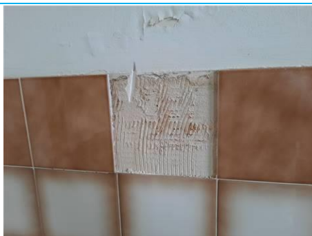
Matériaux : ZPSO-014 Prélèvement : P025 Description : Colle de faïence Localisation : Rez de chaussée - sanitaire chambre 13 Résultat : Absence d'amiante
