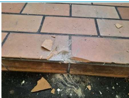
Matériaux : ZPSO-049 Prélèvement : P076 Description : Colle de carrelage Localisation : 1er étage - sanitaire chambre 116 Résultat : Absence d'amiante
