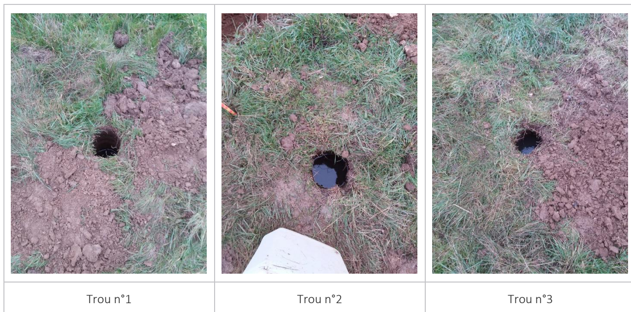
Figure 4 : Illustrations des trous creusés à la tarière pour les essais de Porchet (en eau lors de la phase d'imbibition)
