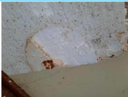
Matériaux : ZPSO-022 Prélèvement : P038 Description : Plot de colle fixant les cloisons Résultat : Absence d'amiante
