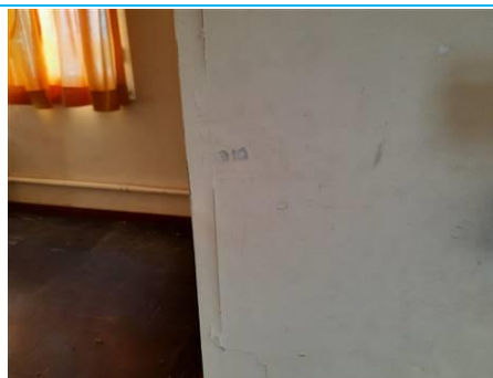
Matériaux : ZPSO-056 Prélèvement : P085 Description : Enduit+peinture+calicot mur Localisation : 1er étage - sanitaire chambre 116 Résultat : Absence d'amiante
