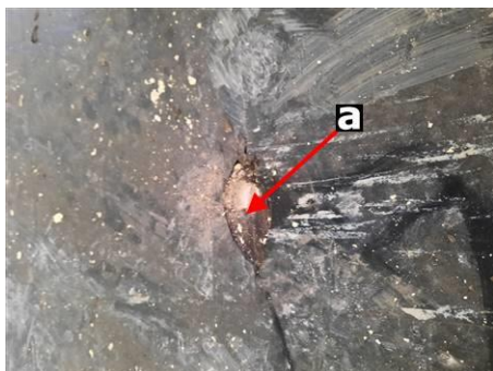
Matériaux : ZPSO-001 Prélèvement : P006 Description : Dalle de sol noire+colle+rag Localisation : Rez de chaussée - chambre 4 Résultat : Présence d'amiante
