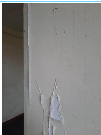
Matériaux : ZPSO-018 Prélèvement : P030 Description : Enduit+peinture+calicot Localisation : Rez de chaussée - chambre 6 Résultat : Absence d'amiante
