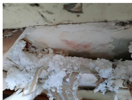
Matériaux : ZPSO-021 Prélèvement : P037 Description : Plot de colle fixant les cloisons Résultat : Absence d'amiante
