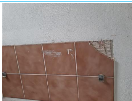
Matériaux : ZPSO-013 Prélèvement : P024 Description : Colle de faïence Localisation : Rez de chaussée - sanitaire chambre 1 Résultat : Absence d'amiante
