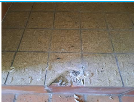
Matériaux : ZPSO-052 Prélèvement : P080 Description : Colle de carrelage anti-dérapant Localisation : 1er étage - douches 1 Résultat : Absence d'amiante
