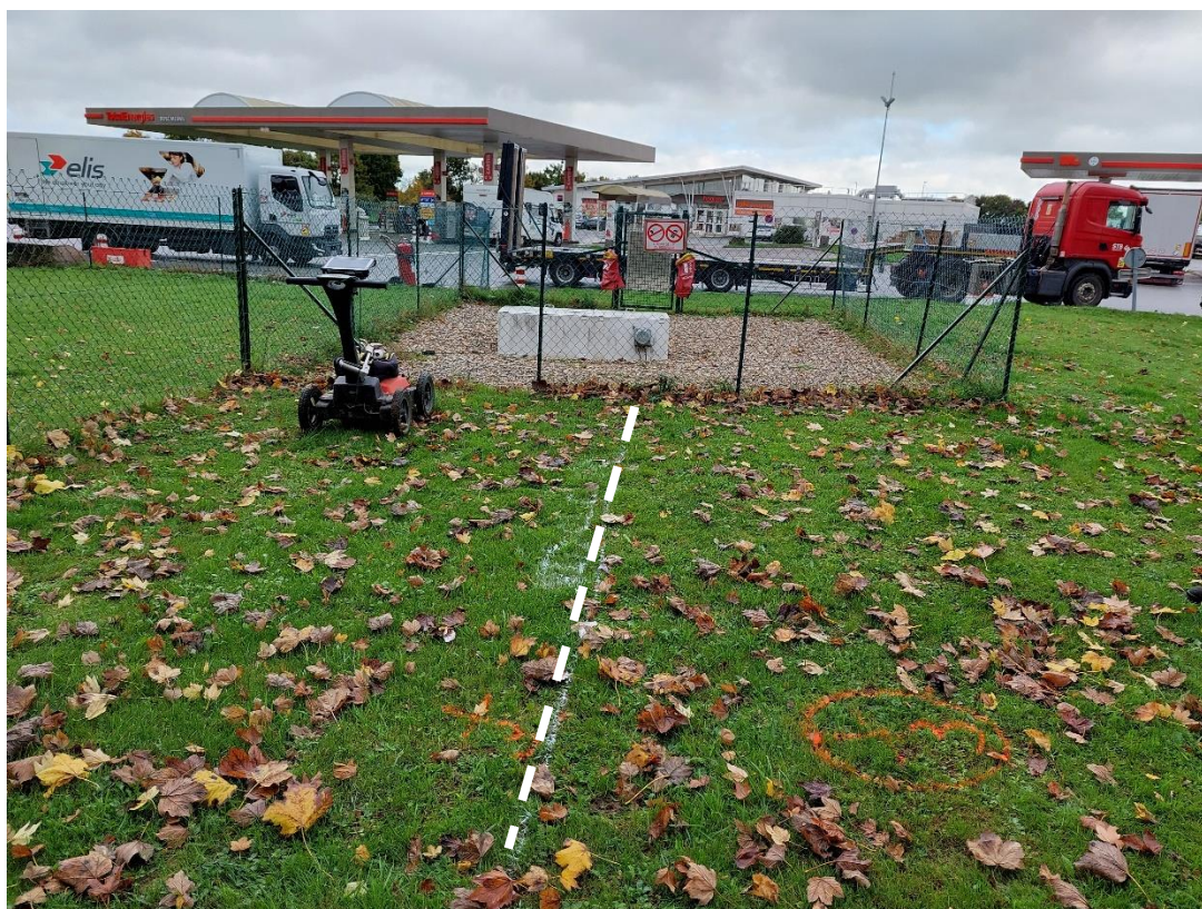
Tracage d'une conduite inconnue vers la cuve enterrée de GPL
