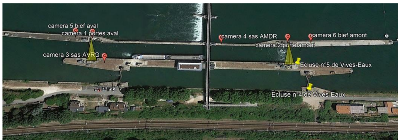
Figure 51-implantation type sur la grande écluse des Vives Eaux
