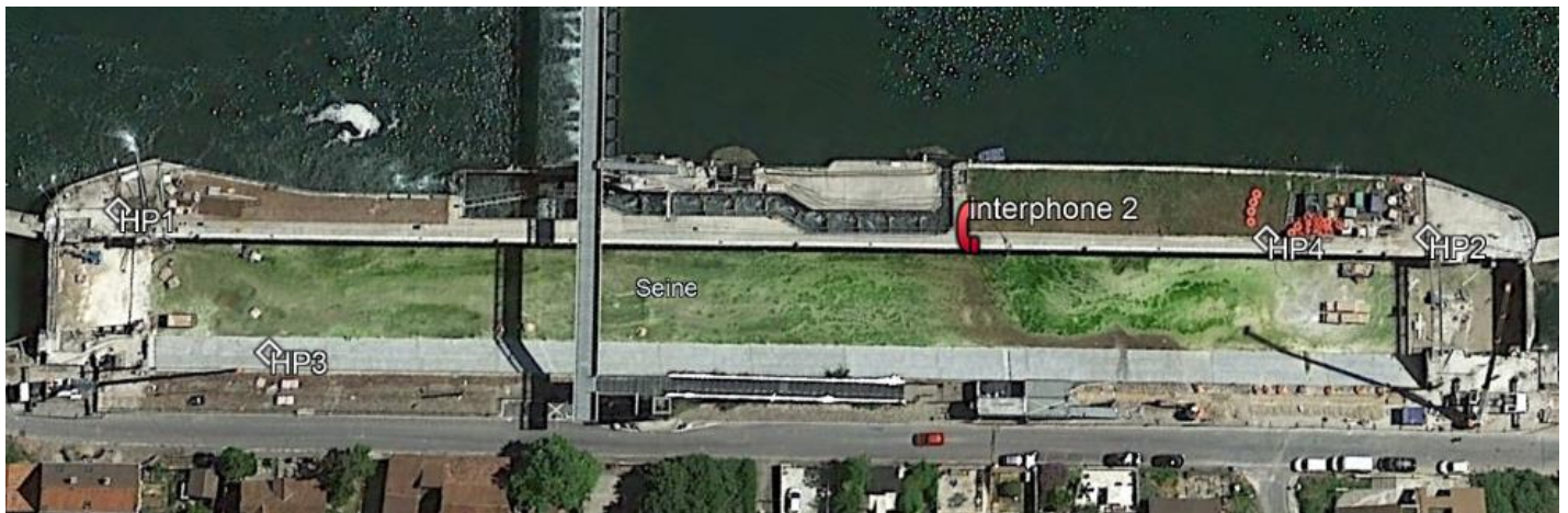
Figure 76-implantation HP et interphone écluse secondaire
