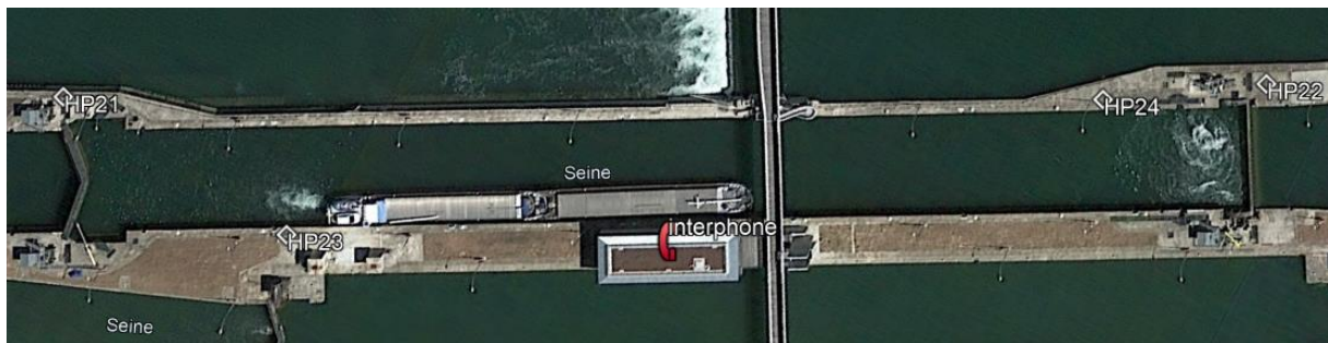
Figure 73-implantation HP et interphone écluse principale
