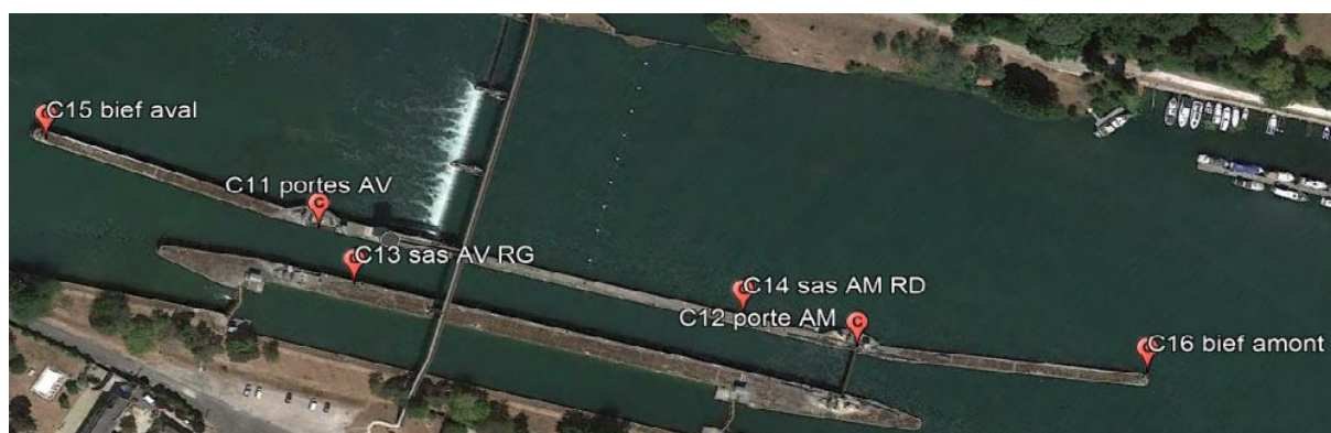
Figure 63-implantation des caméras écluse principale de la Cave
