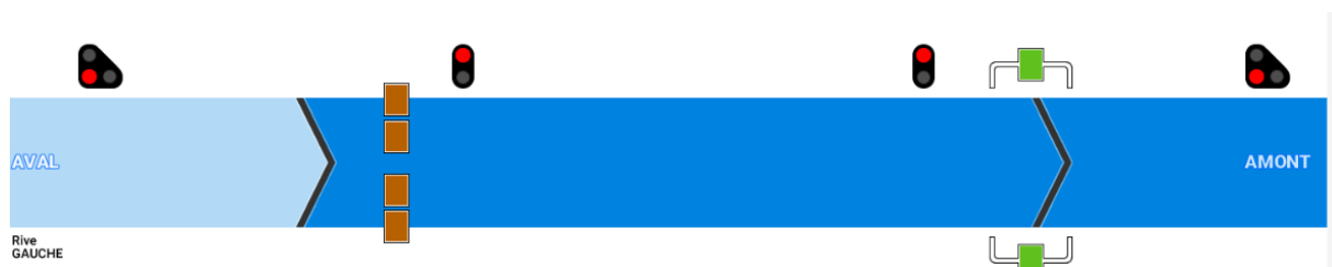
Figure 9-Implantation des feux de navigation
