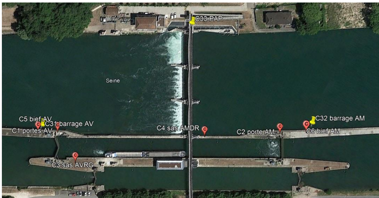
Figure 65-implantation caméras écluse principale
