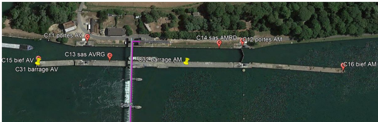
Figure 68-implantation des caméras écluse principale et barrage
