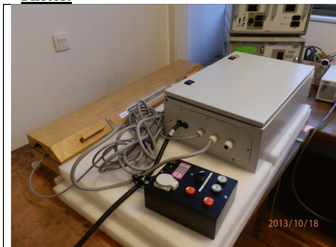
Immunité aux transitoires rapides en salves sur la chaîne de sécurité 110Vac
