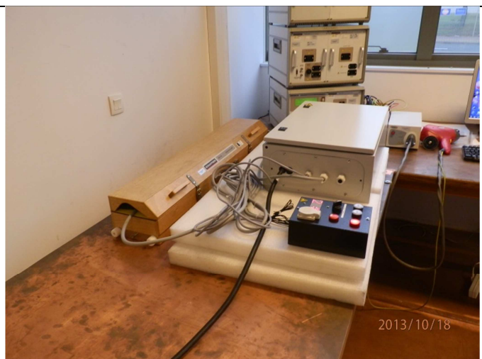
Immunité aux transitoires rapides en salves sur les signaux de commande
