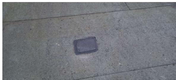
Prélèvement - P7 : Toiture - Lé bitumineux- (Absence d'amiante)
