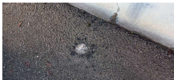
Prélèvement - P2 : Extérieur - Enrobé bitumineux- (Absence d'amiante)
