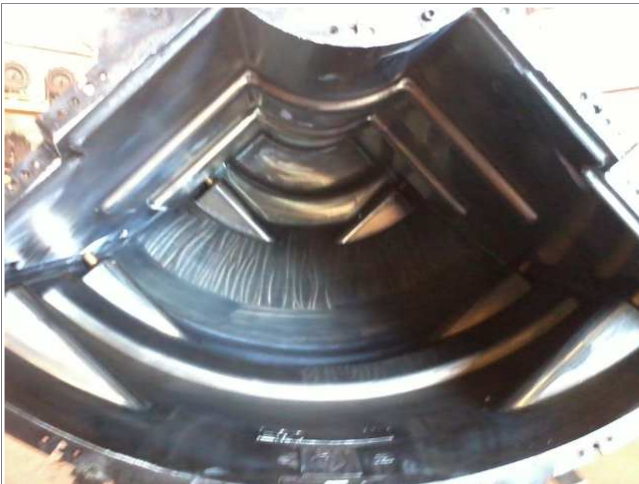
Moule quart de flotteur F50 – vue intérieure
